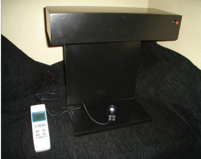
Resim 1-2: Fotopik ve mezopik testlerin yapıldığı düzenek : İlluminator ve 100 Hue testi.
